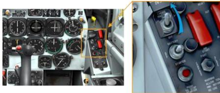
3. 设置 BATTERY-OFF-STARTER 选择开关到 STARTER (1) — **[RAIt + RShift + N]** (短暂), 然后到 BATTERY (2) — **[RAIt + RShift + H]**
