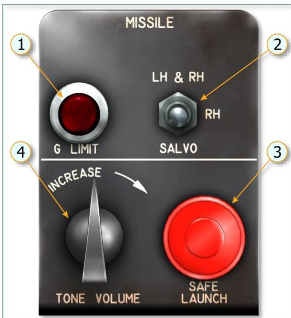
1. G 限制告警灯（超出导弹发射 G 限制）
