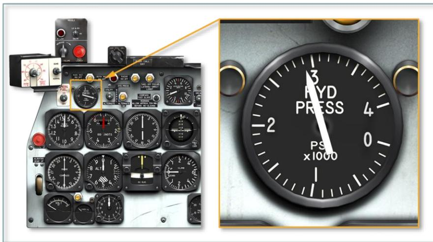
标有 HYD PRESS 的液压表位于仪表板的左上方。该仪器指示由液压仪表选择开关选择的液压系统中流体压力，以磅/平方英寸（PSI）为单位。1,000 PSI 约等于  $70 \text{ kg/cm}^2$ 。该仪表从 0 到 4,000 PSI，刻度以 100 PSI 间隔。
