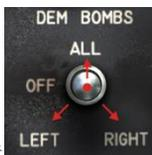
作：将爆破炸弹顺序选择开关置于**除 OFF 以外**的任何位置；将火箭弹释放选择
