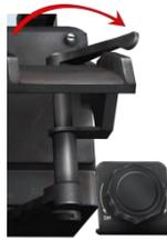
将瞄准具机械锁定杆移至 **UNCAGE**。
