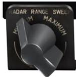
(6) 雷达扫描距离变阻旋钮。该旋钮用于改变雷达输出功率，从而减小或增加目标探测距离。
