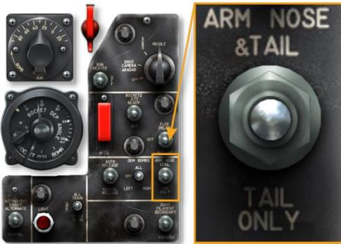
位置：ARM NOSE&TAIL—NEUTRAL – TAIL ONLY。用于爆破炸弹。当开关置于 ARM NOSE&TAIL 位置时，炸弹会在受到撞击时立即爆炸（弹头和弹尾引信都解除保险）。将开关置于 TAIL ONLY 仅解除弹尾引信的保险，以进行延时引爆。如果开关设置在 NEUTRAL 位置，则炸弹引信处于未解除保险状态，炸弹扔掉后不会被引爆。
