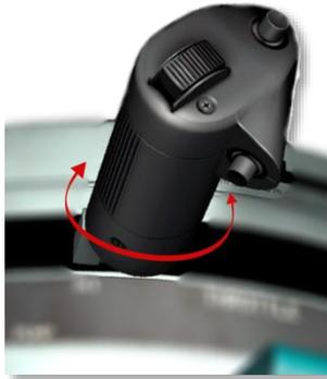
节流阀中包含一个可扭动把手：当机枪瞄准具的自动功能失效或在地面操作期间，当雷达测距由于地面效应（海拔低于 **6000** 英尺）而变得不稳定时，它允许在射击操作期间进行手动测距。
