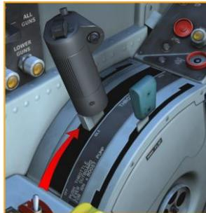
提示。一旦节流阀控制移至 **IDLE**, 启动过程将继续, 而无需飞行员的参与。
