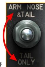
9. 在开始俯冲前，将炸弹解除保险开关设置到所需位置（不要离开中置位置，否则炸弹不会爆炸）。然后按下并按住节流阀中的瞄准电气锁定按钮以稳定掩模图像**[Tab]**（如果之前未稳定）。
