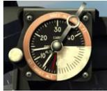
(9) 轰炸高度计。这个高度计是轰炸武器系统的一部分。它基于人体工程学考虑安装在瞄准具上。有关更多详细信息，请参阅轰炸高度计部分。
