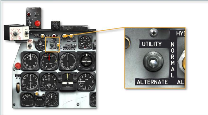
三位液压压力表选择开关位于液压表的右侧。它将液压压力表连接到三条液压管路中的一条——通用，正常或备用。当开关设置为 **UTILITY**（通用液压系统），**NORMAL**（飞行控制正常液压系统）或 **ALTERNATE**（飞行控制备用液压系统）时，相应系统的压力由压力表指示。液压指示系统由三相交流总线供电。
