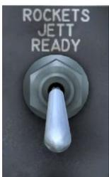
该开关允许所有火箭弹在紧急情况下通过炸弹—火箭弹释放按钮丢弃。
