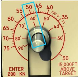
所选择的俯冲角度（在示例中，俯冲角度为  $60^{\circ}$ ，在海拔 **15,000** 英尺，释放速度 **288** 节下，释放高度为 **5,000** 英尺）。
