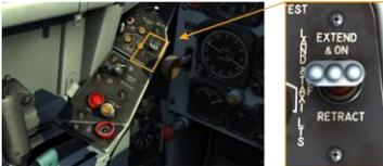
着陆和滑行灯开关，也用于伸出/收回灯头（**EXTEND** 和 **ON**—伸出且接通灯，**OFF**—熄灭伸出灯头；**RETRACT**—收回灯头）
