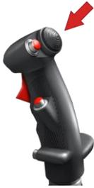
配平完成通过操作配平开关后释放，或减少驾驶杆载荷后驾驶杆定位在保持期望的飞行姿态。向两侧按住正常配平开关给电动横向配平舵机通电。向前或向后按住正常配平开关给电动纵向配平舵机通电。配平舵机在通电时，重新定位人感系统的弹簧。反过来，弹簧施加必要的力以建立杆的新的中置（空载）位置，消除或减少驾驶杆负载。正常配平电路由主要总线供电。
