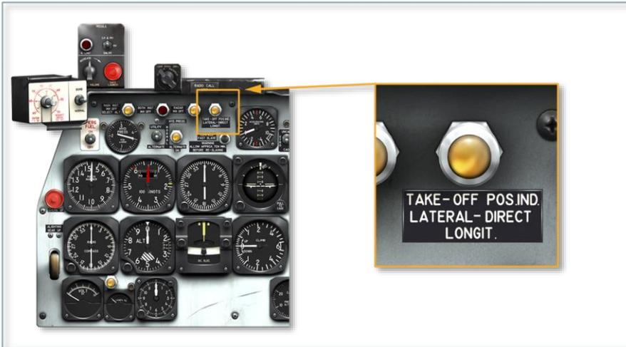
仪表板上由主要总线供电的琥珀色灯指示副翼，水平尾翼和方向舵处于起飞配平位置（见图 5.1）。只要这些控制面中的任何一个被配平到其起飞位置，灯就会亮起（详见[此处](#)）。当重置相应的配平开关时，灯将熄灭。在之后任意控制面被起飞配平，它将再次亮起。
