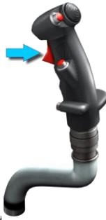
7. 按下扳机，将扳机扳到第二级并保持到发现导弹离开飞机为止。
