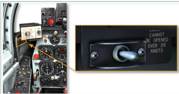
手动 PIP 控制单元。手动 PIP 控制 (MPC) 单元 (图 4.1, 1) 是手动 PIP 控制系统的一部分。该系统被纳入 A-4 瞄准具, 以允许更准确和安全的俯冲轰炸。[详情参见这里](#)。
