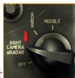
当机枪-导弹选择开关设置在除 OFF 外任意位置时，雷达设备开始运行。
