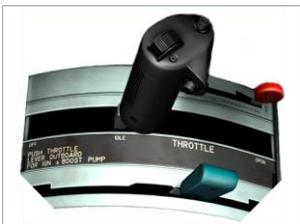
发动机节流阀机械连接到燃油关断阀和主燃油控制器与紧急燃油控制器([3.2.3](#))。当主开关接通时，向发动机启动系统和燃油关断阀供电。然后，当节流阀从 OFF 变为 IDLE 时，燃油关断阀打开。燃油供应给发动机启动系统和发动机本身（点火系统在转速（RPM）达到约 23%时自动关闭）。当发动机运行时，节流阀位置确定目标转速（RPM）。
