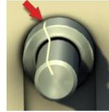
RCM 以滚动标签)。控制旋钮设置由其白色指针指示。固定表盘以密耳为单位进行校准；当已知俯冲角度和目标高度时使用它。在攻击情况下对折叠式表盘进行选择，每一个都有两个刻度。内部刻度标记为 **DIVE ANGLE**，对应于  $20^{\circ}$  至  $90^{\circ}$  的攻击俯冲角度，增量为  $10^{\circ}$ 。外部刻度标记为 **INDEX ALTITUDE**，表示推荐的炸弹释放高度（海平面高度，数百英尺），具体取决于
