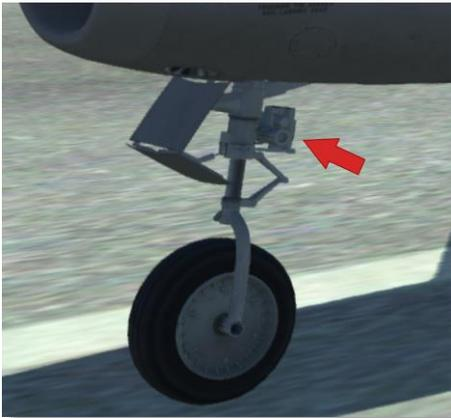
图 4.5 前轮转向机构
