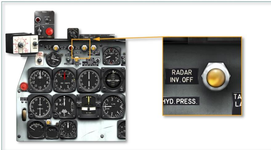
通过点亮位于上仪表板上琥珀色主雷达逆变器故障告警灯来指示主雷达（单相）逆变器的故障。该灯为推入测试型，由主要总线供电。
