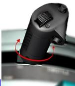
逆时针转动扭转手柄直到它停止[;]（增加距离）—对于更改 A-4 瞄准具距离输入模式：从手动到雷达测距单元。
