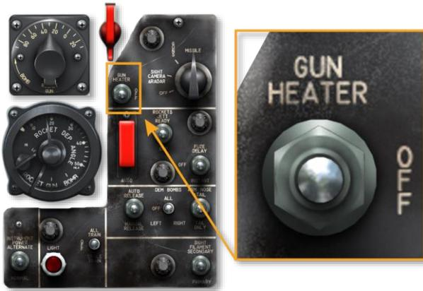
4. 在中央基座上的机枪枪管加热开关（预防机枪在低温结冰或高湿度条件下受到干扰）
