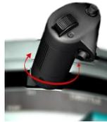
旋转节流阀手柄（手动控制测距），使掩模圆圈连续对准目标，并开始跟踪直到接近至适当距离。
