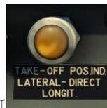
3. 将升降舵配平调整片设置为起飞位置：为此，选择起飞配平位置指示灯，然后按住 [RCtrl + ]。驾驶杆位置指示器将开始缓慢向下移动。一旦达到起飞配平位置，灯泡将短暂亮起并熄灭。现在升降舵配平调整片设置在起飞位置。
