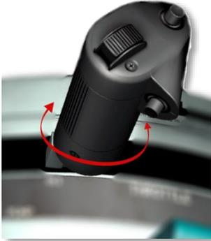
流阀中（无法用鼠标旋转节流阀；必须操作键盘或操纵杆）。扭转手柄改变了距离选择旋钮的参数，进而影响陀螺进动速率。投射有瞄准具掩模图像的陀螺齿轴玻璃根据陀螺仪的操作参数进行更大或更小的角度偏转。瞄准具掩模图像转变为视场，使得飞行员必须沿着目标速度矢量“移动”飞机（和机枪）的 X 轴，以便使掩模图像维持在目标上。瞄准点偏移取决于上述因素。
