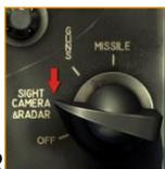
**CAMERA&RADAR**（用于陀螺仪旋转和设备调定）。在打开陀螺仪前，应该将瞄准具机械锁定（即，瞄准具机械锁定杆应设置为 **CAGE**）。
