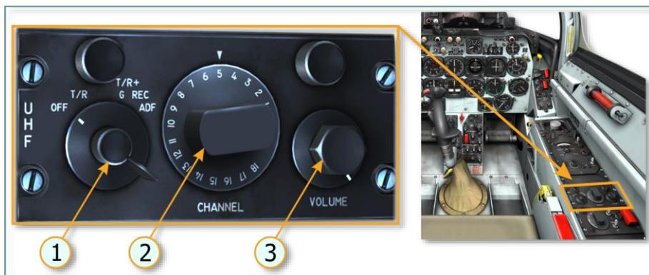
图 7.1 UHF 指令无线电 — AN/ARC-27
