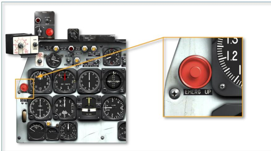
位于仪表板左侧中央部分有保护的起落架紧急收起（或“紧急上位”）按钮忽略起落架地面安全开关并允许在地面上收起。
