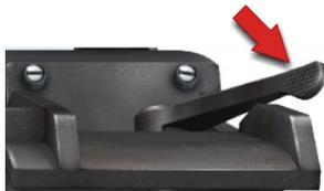
(3) 机械锁定杆。瞄准具机械锁定杆允许机械地锁定瞄准具陀螺仪以防止飞机处于地面上时（移动或不移动）以及陀螺仪故障时的损坏。
