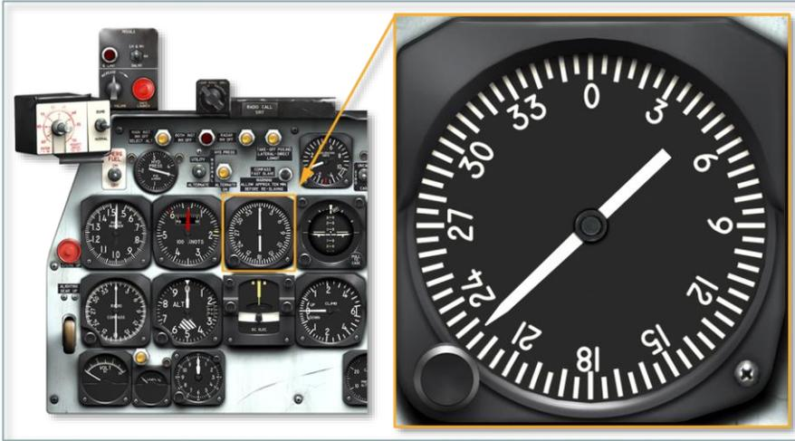
位于仪表板上的 V-8 从属航向（陀螺仪）指示器是一种导航设备，可显示飞机当前的磁航向，范围为 0 到 360 度。在上图中，该装置显示出 226 度的航向。
