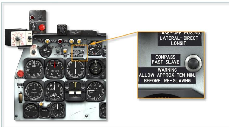
快速同步按钮位于仪表板上，标记为 **COMPASS FAST SLAVE**。在飞行中，通过重置陀螺仪至直立与同步位置，以快速消除传感器与陀螺单元之间的大角度偏差。在陀螺仪已经触发其机械制动的机动后，这种重新对准是非常必要的。例如，一分钟的特技飞行操作可能导致 **3-4** 度的角误差。
