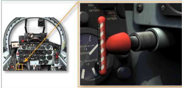
受保护的紧急抛弃手柄具有两个确定的释放位置，并允许选择性地机械释放外部负载。顺时针旋转手柄至止动挡块处，然后尽可能将其拉出（约 4 英寸），仅释放外侧可抛油箱。当手柄没有被旋转就被完全拉出（大约 10 英寸）时，所有可抛油箱（或所有外部负载）同时被释放至其。将紧急抛弃手柄顺时针旋转到止动挡块处，然后尽可能地拉出手柄（大约 4 英寸），当挂载了无鳍的 200 加仑油箱时，在油箱挂架中产生一次电脉冲，激活爆炸炸药强行抛弃油箱。
