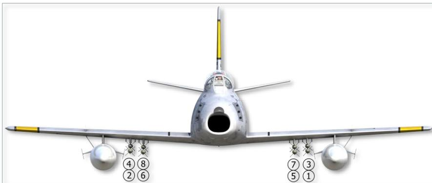
图 6.14 火箭弹发射顺序 (8 HVAR)
