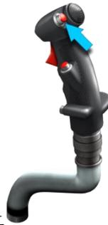
6. 在飞越目标中心时,按下并按住驾驶杆上的炸弹-火箭弹释放按钮,并在 2 秒钟内立即机鼻向上倾斜到 4G,同时增加推力至最大值。
