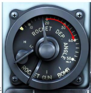
7. 在瞄准具选择单元上：操作火箭弹设置杆，设置火箭下坠校正：
