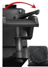
2. 将瞄准具机械锁定杆置于 **UNCAGED**（右侧）。
