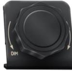
(4) 瞄准具掩模调光控制旋钮。该旋钮用于调节瞄准具掩模照明的强度。在不操作瞄准器时应将 **DIM** 放置在 **DIM** 位，以防止在电压波动时损坏掩模灯泡。
