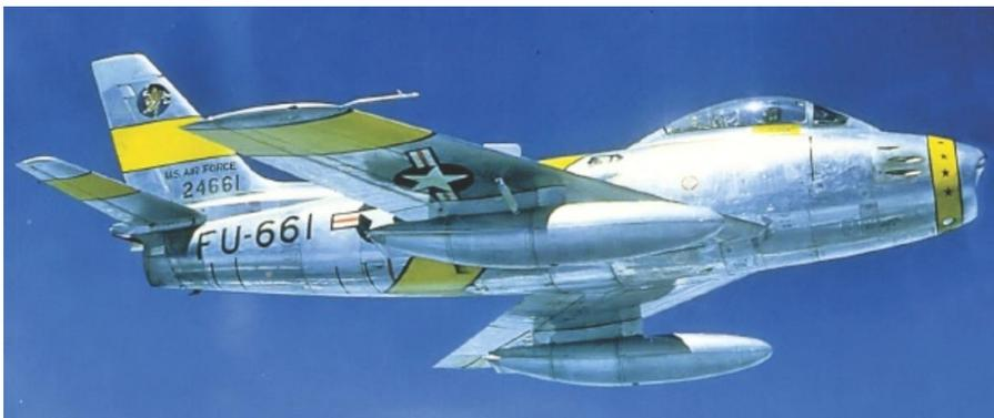
图 1.15 带“6-3”机翼的 F-86F
