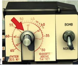
置时，根据 MPC 单元中的控制旋钮位置，瞄准具掩模电气锁定在从 0 至 174 密耳的角度。
