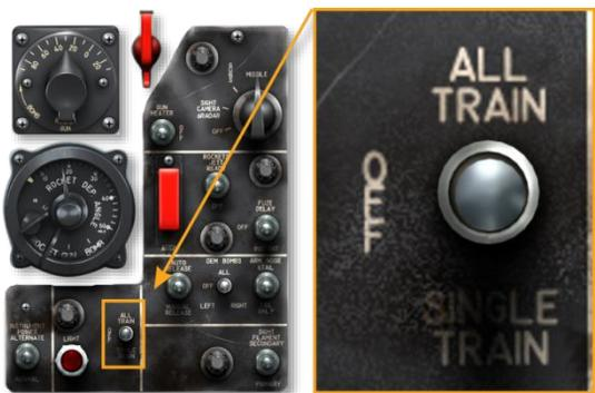
提示。由于没有破片炸弹，因此尚未在模拟中功能化此开关。
