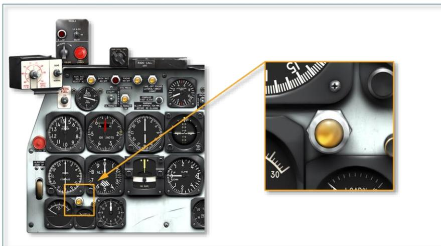
当发电机发生故障，发电机电压降至需要切断逆流继电器时，或发电机开关 OFF 时，由主要总线电力点亮位于仪表板左下方的红色发电机警告灯。此外，如果发电机电压超过 31 V，发电机会自动切断电路，发电机告警灯亮起。告警灯的亮起表明所有由辅助总线供电的设备都不再工作，且电池正在为主要总线供电；因此，应关闭所有其他非必要的电气设备以节省电池电量。
