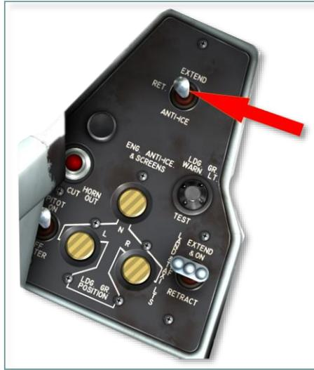
图 5.9 发动机保护开关
