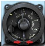
将瞄准具功能选择杆设置为 **GUN** **[LCtrl + D]**（顺时针旋转）或 **[LAlt + D]**（逆时针旋转），
