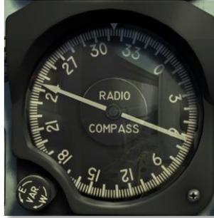
该导航设备在仪表板上有一个指示器，在右侧控制台上有一个控制面板，参见图 7.2. 控件可启用自动或手动航向搜索。
