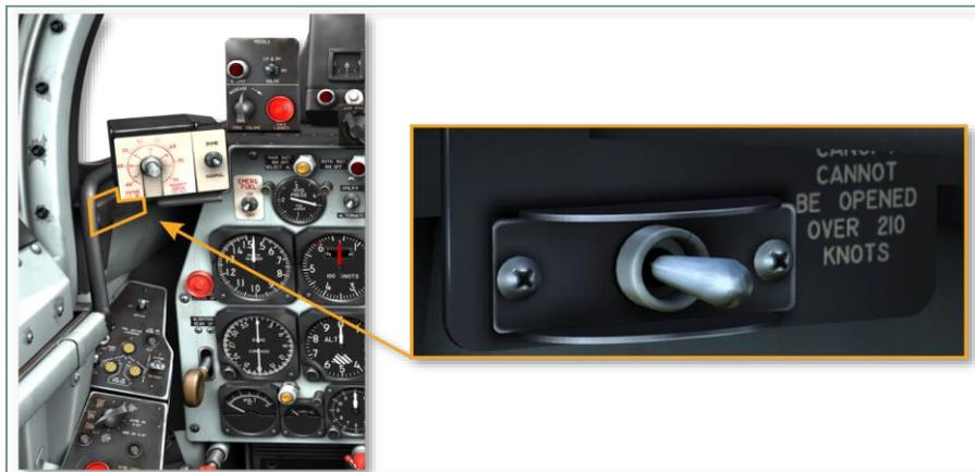
图 3.8 座舱盖开关
