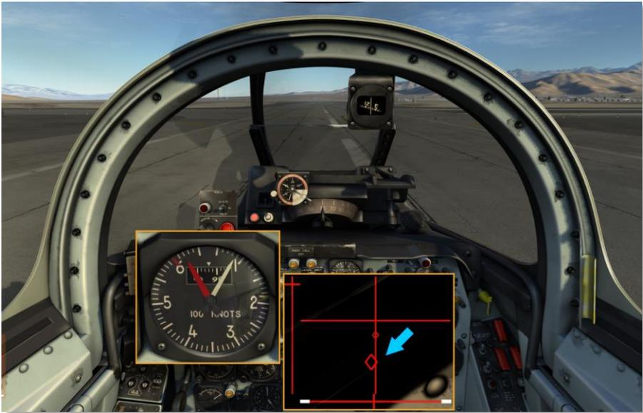
图 8.1 当速度比前轮抬起所需的速度低 20-30 节时驾驶杆的位置
