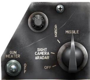
射击安全开关（机枪-导弹选择开关）位于 SIGHT & CAMERA RADAR。按下扳机到第一级止动以操作照相机，只要按下扳机，该摄像机将继续运行，在从 0 到第 5 秒时超限。在机枪，火箭弹或导弹发射时，照相机也能工作。
