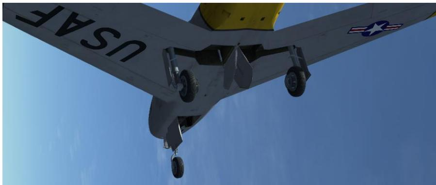
前起落架向后收起至机身下部的前起落架舱中。当起落架收起时，前起落架转动 90 度，使得收回的机轮水平（在飞行方向上）。主起落架安置在机翼。收起主起落架使其移动到机翼中部的隔舱内。通过液压致动器完成收起和伸出。应急释放可以通过 [通用液压系统](#) 中的剩余液压完成。机轮制动器为液压蹄块式。
