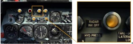
2. 在操作瞄准具前，将中央基座上的机枪—导弹选择开关放在 **SIGHT CAMERA&RADAR**（用于陀螺仪旋转和设备安置）。在打开陀螺仪前，应将其机械锁定（即，瞄准具机械锁定杆应设置为 **CAGE**）。
