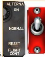
常液压助力系统到备用液压助力系统的切换，用于在维护期间检查转换功能，并且在真实故障的情况下用作自动转换为备用。
