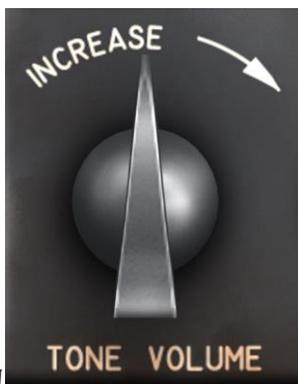
4. 转动音量控制旋钮，使背景信号处于低音量。
