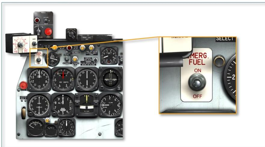
应急燃油开关位于仪表板的左上角，可以手动启动应急燃油控制系统。
