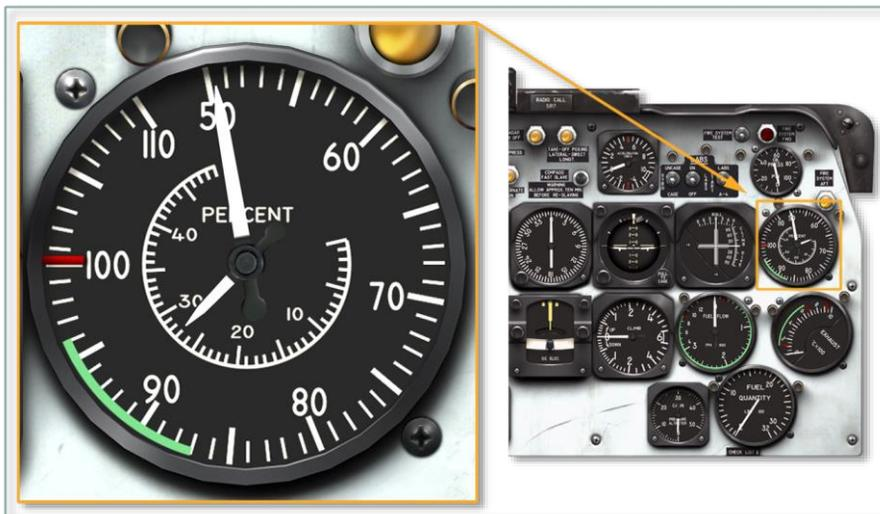
位于仪表板上的转速表指示涡轮转速。它以占最大额定转速（RPM）（100% 对应于 7950 RPM）的百分比记录发动机转速。当与排气温度计的指示结合操作时，该指示允许在不超出发动机限制的情况下精确地设定发动机推力。转速计从转速计发电机接收电力，转速计发电机与发动机转子轴啮合，因此不依赖飞机的电气系统。
