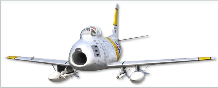
图 6.16 带有空对空导弹 GAR-8 和油箱的飞机
