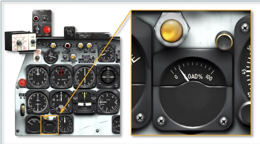
位于仪表板左下方的负载计标记为 **LOAD**，表示正在操作电力占总计系统电流强度的百分比。
