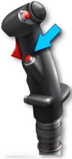
在检测到目标后，雷达锁定目标，开始测量锁定目标的距离并将测量数据提供给雷达。为了超限雷达锁定并将雷达移到另一个目标（如果有多个目标），飞行员需要暂时按下并释放控制杆上的雷达目标选择按钮（**[Enter]**），在这种情况下，雷达将放弃先前锁定的目标，将自动重置/循环并从最小扫描距离开始扫描。这允许重新锁定最近（最关键）的目标，同时瞄准具自动切换到 GUN 模式（连接到射击分系统）。
