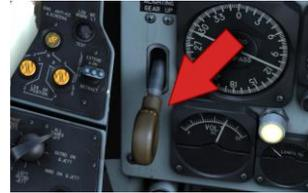
驾驶舱内有一个位于仪表板底部的起落架控制手柄。
