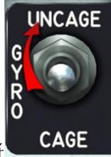
准确,并通过将开关置于 UNCAGE 来解锁 LABS 陀螺仪。
