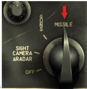
1. 将机枪—导弹选择开关转到 MISSILE。
