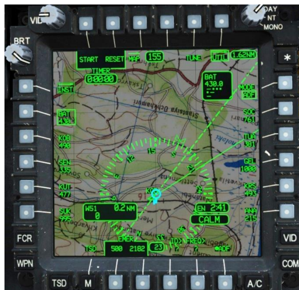
Figure 204. MPD TSD Page, UTIL Sub-Page
