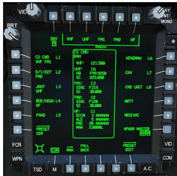
Figure 224. MPD COM Page, Preset Format
