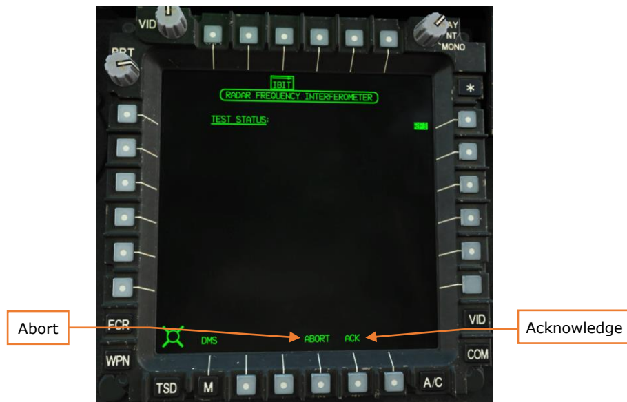
Figure 138. MPD DMS Page, IBIT Sub-Page, Status Format
